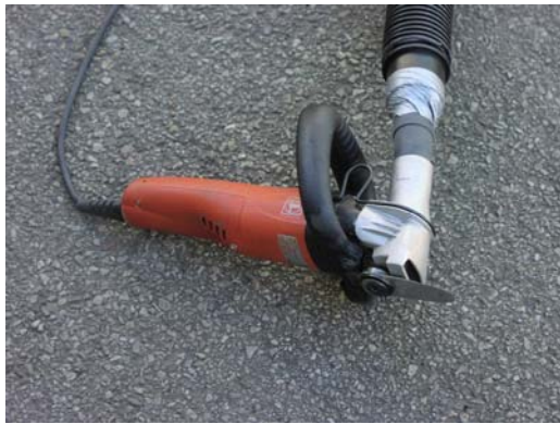
Bild 1: Ny oscillerande kniv från Fein, modell FSC 1.6, som användes för skärning av PCB-haltig fogmassa.
