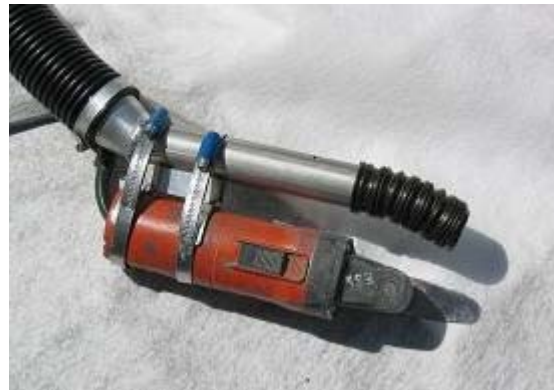
Bild 2: Oscillerande kniv från Fein, modell FSN 400E med SP-utsug med Riktaflex.
