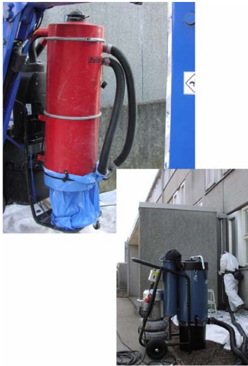
Bild 7: Dammsugare av märkena Pullman och Nederman användes vid mätningarna.
