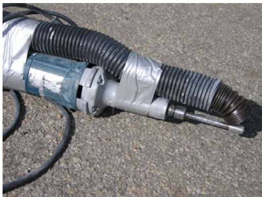
Bild 3: Slipverktyg för slipning i svåråtkomliga utrymmen. Till raxslipen från Bosch (GGS 27LC) är ett utsug med en ställbar slang monterad.
